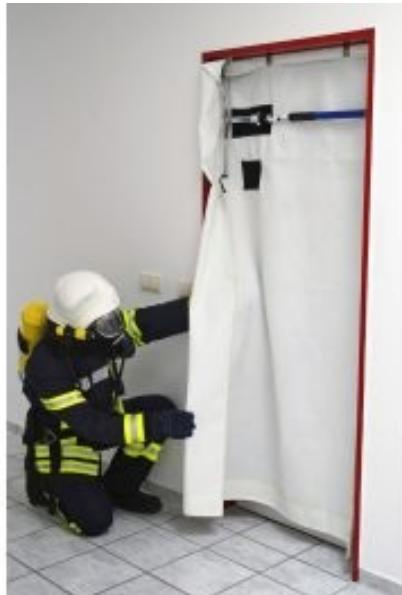
L'installation de l'obturateur de fumée est indépendante du matériau du cadre de porte et convient pour des largeurs de porte de 90 à 150 cm. Le matériel spécial en fibre de verre est très stable et présente une résistance élevée à la température (jusqu'à 600°C). Il est étanche à la saleté et à l'eau et donc facile à nettoyer. Le RSS peut être transporté dans un sac de transport ou dans un panier tubulaire.
