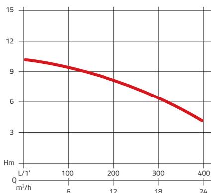
Das Diagramm zeigt Ihnen die Pumpleistung der Rössle Tauchpumpe MEGA in m<sup>3</sup> pro Stunde in Relation zur Pumphöhe.
