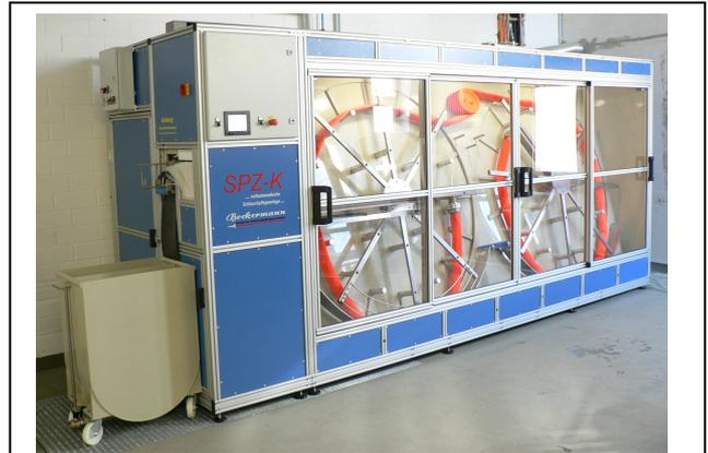
**Vorbildlich:** Vollautomatisches Wickeln mit Entwässern des Schlauches im Anschluss an die Druckprüfung. Optimaler Personenschutz durch die Sicherheitscheiben.
