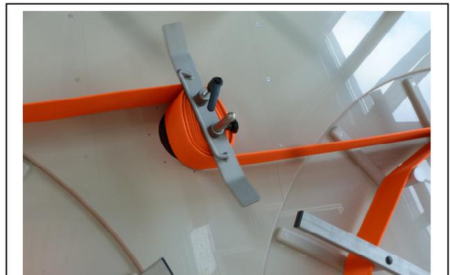
Die TOP-Schlauchführung für die Wickeleinrichtung ermöglicht das optimale Aufwickeln für alle Schlaucharten sowie die einfache Entnahme des Schlauches aus der Anlage.
