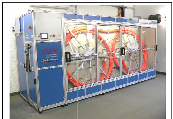
**Höchste Sicherheit** bei der Druckprüfung der Schläuche zwischen Haspelscheibe und sternförmigem Berstschutz in Verbindung mit bruchfesten Schiebetüren für optimale Übersicht
