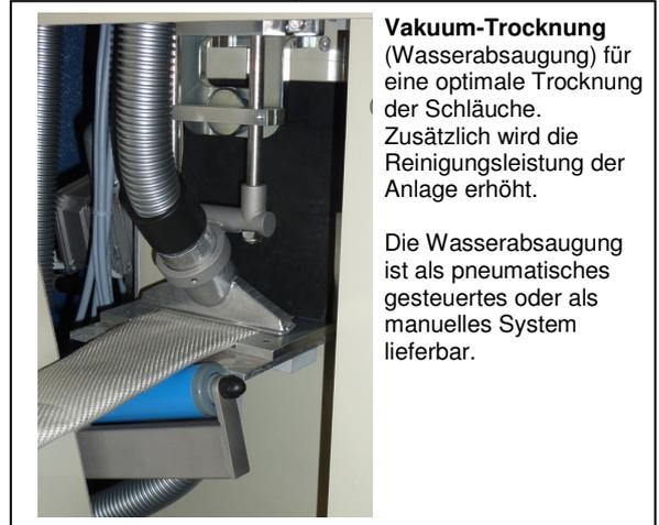
**Vakuum-Trocknung** (Wasserabsaugung) für eine optimale Trocknung der Schläuche. Zusätzlich wird die Reinigungsleistung der Anlage erhöht.
