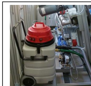
3-stufiger Naßsauger mit eingebauter Tauchpumpe für automatische Entleerung
