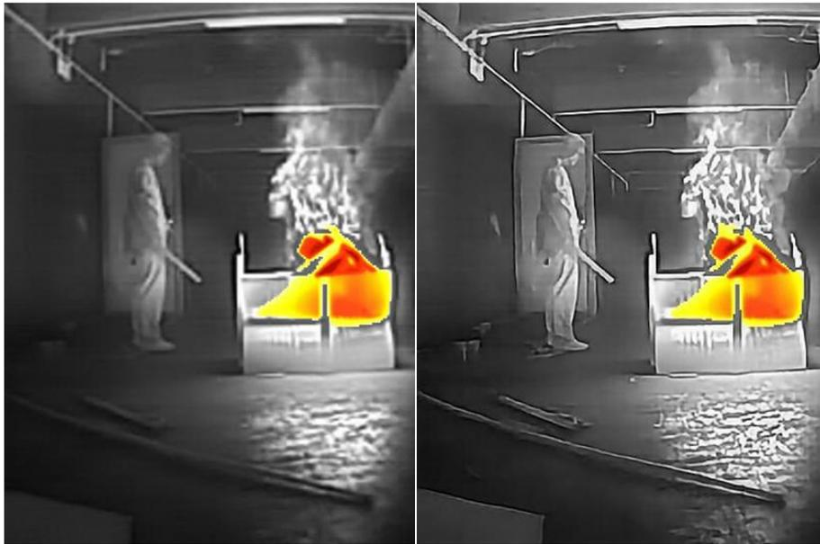
Die SuperIR-Technologie wird von einem neuronalen Netzwerk-Algorithmus unterstützt, der auf einem umfangreichen Datensatz von Bildern trainiert wurde, um die Qualität thermischer Bilder zu verbessern. Das F25 verfügt über Echtzeit-SuperIR, was die Bildklarheit erheblich verbessert und gleichzeitig eine reibungslose Leistung aufrechterhält.
