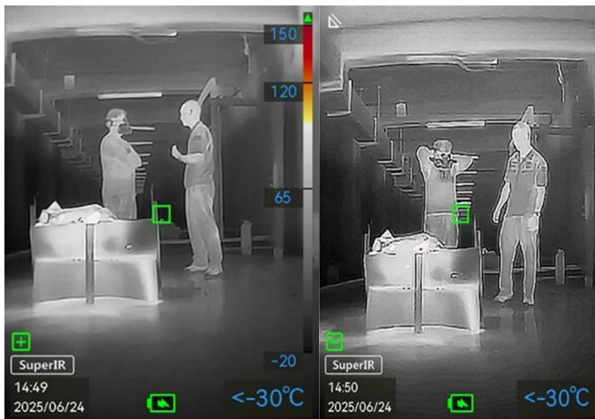
Falschfarben-thermische Überlagerungen basieren auf Temperaturkarten, die visuelle Details in heißen Bereichen abflachen. ODE verbessert die Klarheit, ohne die thermischen Daten zu verändern. Mit dieser Funktion aktiviert wird die Zielkontur klarer, aber das Rauschen des Bildes wird entsprechend erhöht.
