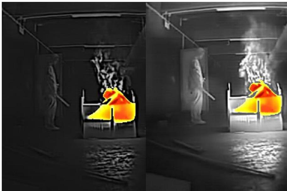
AGC passt den Gain dynamisch für jedes Pixel basierend auf der Temperaturverteilung der Szene an. In Wärmebildern erscheinen Hintergrundbereiche mit geringen Temperaturunterschieden (wie kalte Wände oder Lagerzonen) oft flach. Auto AGC erweitert den Kontrast in diesen Regionen und lässt subtile Merkmale sichtbar werden.
