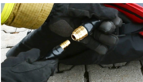
Druckluft-Kupplung: weiblich für Schlauchdurchmesser 9mm; Nennweite 7,2mm
