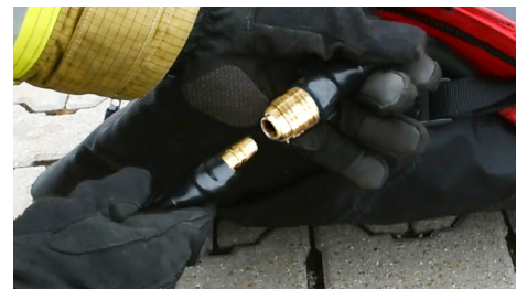
Druckluft-Kupplung; weiblich für Schlauchdurchmesser 9mm; Nennweite 7,2mm
