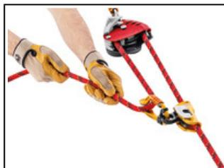
Die integrierte Umlenkrolle mit Rücklaufsperrung und sehr großer Laufrolle mit gekapseltem Kugellager lässt nur eine Laufrichtung zu und gewährleistet einen ausgezeichneten Wirkungsgrad beim Heben von Lasten.
