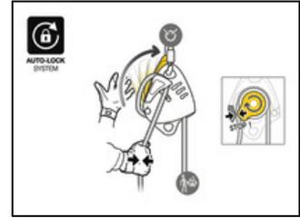
Das AUTO-LOCK-System blockiert das Seil automatisch, wenn der Hebel nicht benutzt wird.
